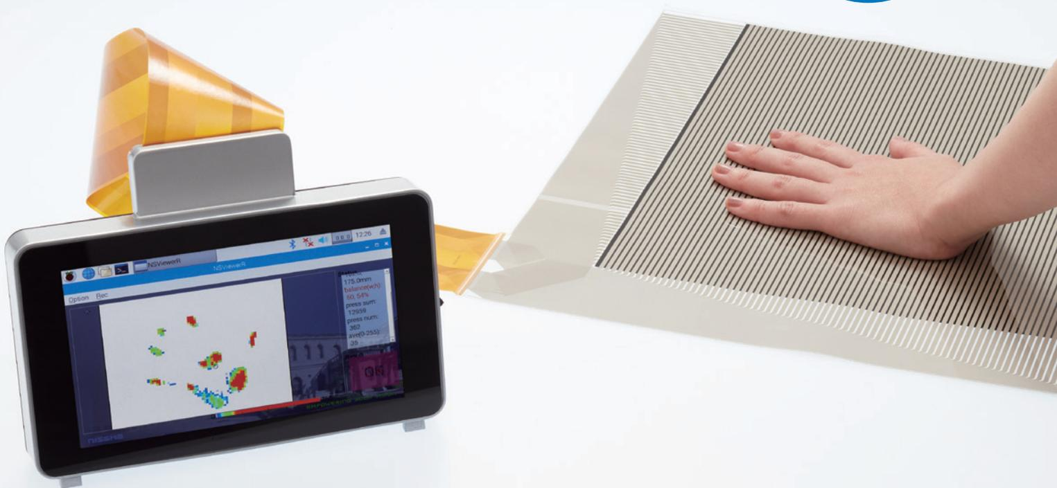
高解像度の薄型センサーで様々な加圧プロセスを定量的にモニタリング
